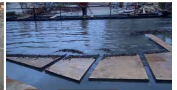
Imágenes del modelo en plataforma marítima. Se prueba oleajes y tsunami. Fuente: Autores.
