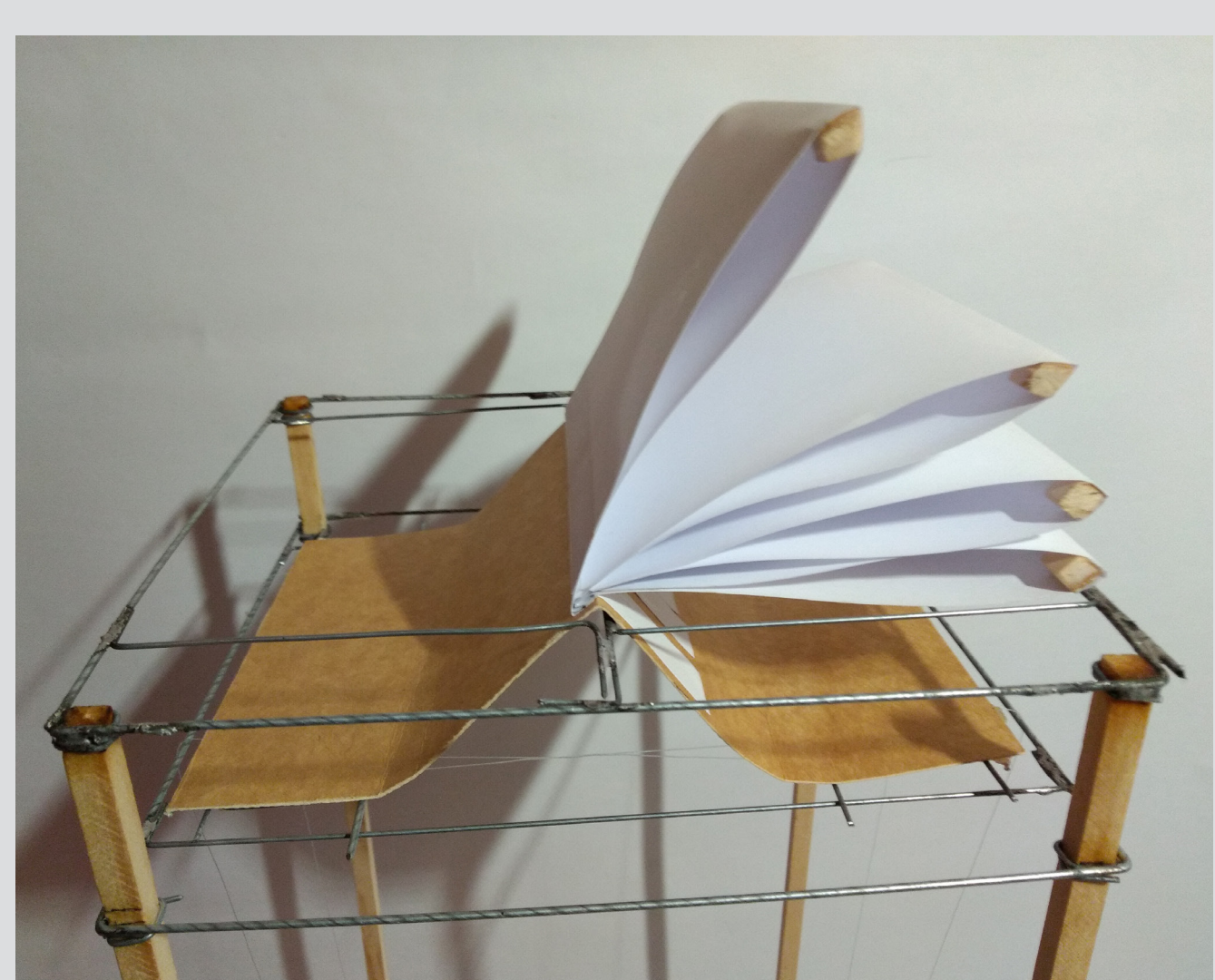
Vista frontal del mecanismo, cada hoja tiene un peso en sus extremos para ayudar a la caída de cada una en su accionar
