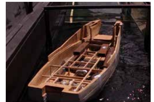
Pruebas de estabilidad en canal de olas
