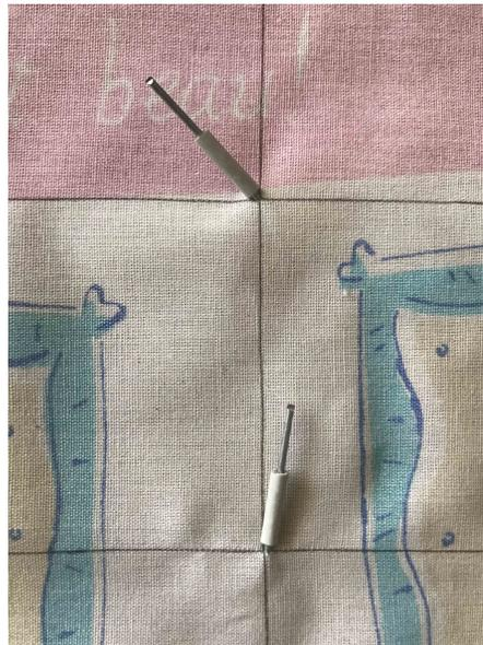
Al parecer, los trapanes verticales de los costados, al ser muy delgados o no tener otro de refuerzo, se pandearon hacia el interior al momento de verter el yeso, por ende, el perímetro del muro no quedó completamente cuadrada. Por otra parte, las "almohadillas" de más arriba no quedaron lo suficientemente abultadas como las de más abajo, sin embargo, se asume que es por recibir la misma presión que las de más abajo.
