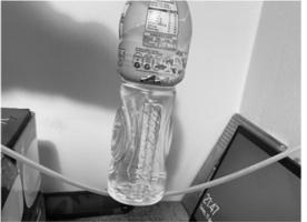
En este trozo donde la fibra es longitudnal se puede apreciar que existe una defomacion mayor en la madera. Hasta que llega un punto que la deformacion es tanta que termina por quebrase la tabla de madera.
