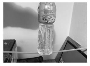
En este trozo donde la fibra de transversal se puede apreciar que no hay una deformación mayor en la madera.
