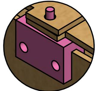
Encaje por rotación de la base en sacado de lateral 1
