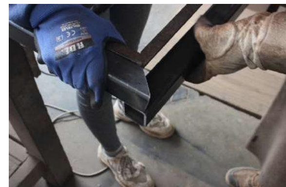
Fig.321 Unión de fierros, corte en ángulo. Elaboración propia
