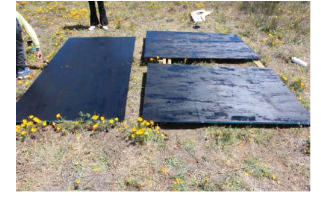
Fig.244 Aplicado Carbolineo. Elaboración propia
