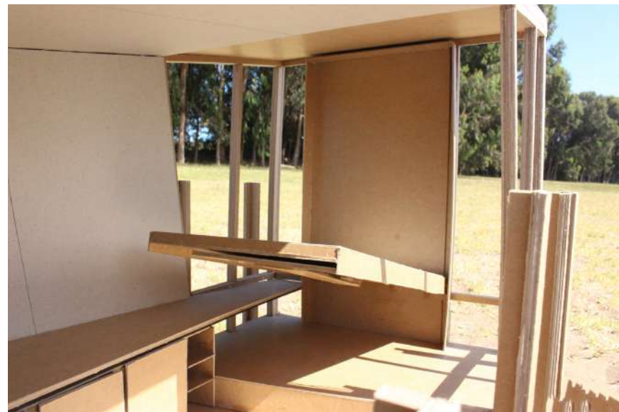
Fig.337 Maqueta 1:8, secuencia despliegue cama. Elanoración propia
