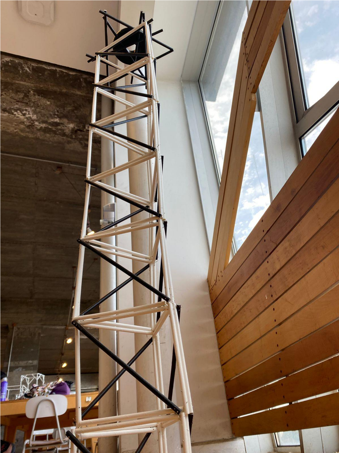
La estructura aguanto los 0.5 kg, tiendo un total de 7 pisos, utilizando verticales para la distribución de peso u que se mantenga la forma.
