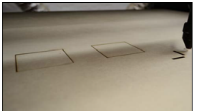
Finalmente, se cortaron las superficies para los moldes.
