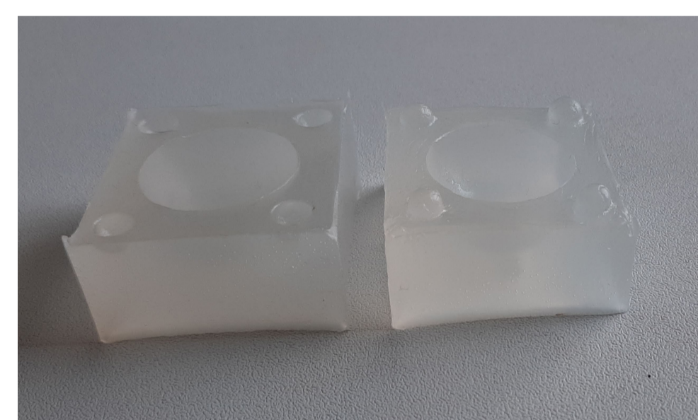
Primera prueba de silicona, se realizó un molde de esfera. Dado el grosor de los muros del molde resulta difícil desmoldar sin deformar o romper la pieza realizada al mismo tiempo que el uso de la silicona resulta ineficiente ya que se pierde mucho material.
