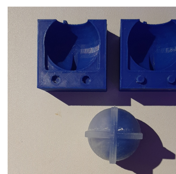
Quedando así un molde con mayor elasticidad y con mayor flexibilidad para desmoldar la preparación en su interior. El espesor óptimo para tener estructura firme y flexible varía entre 3 a 5mm.
