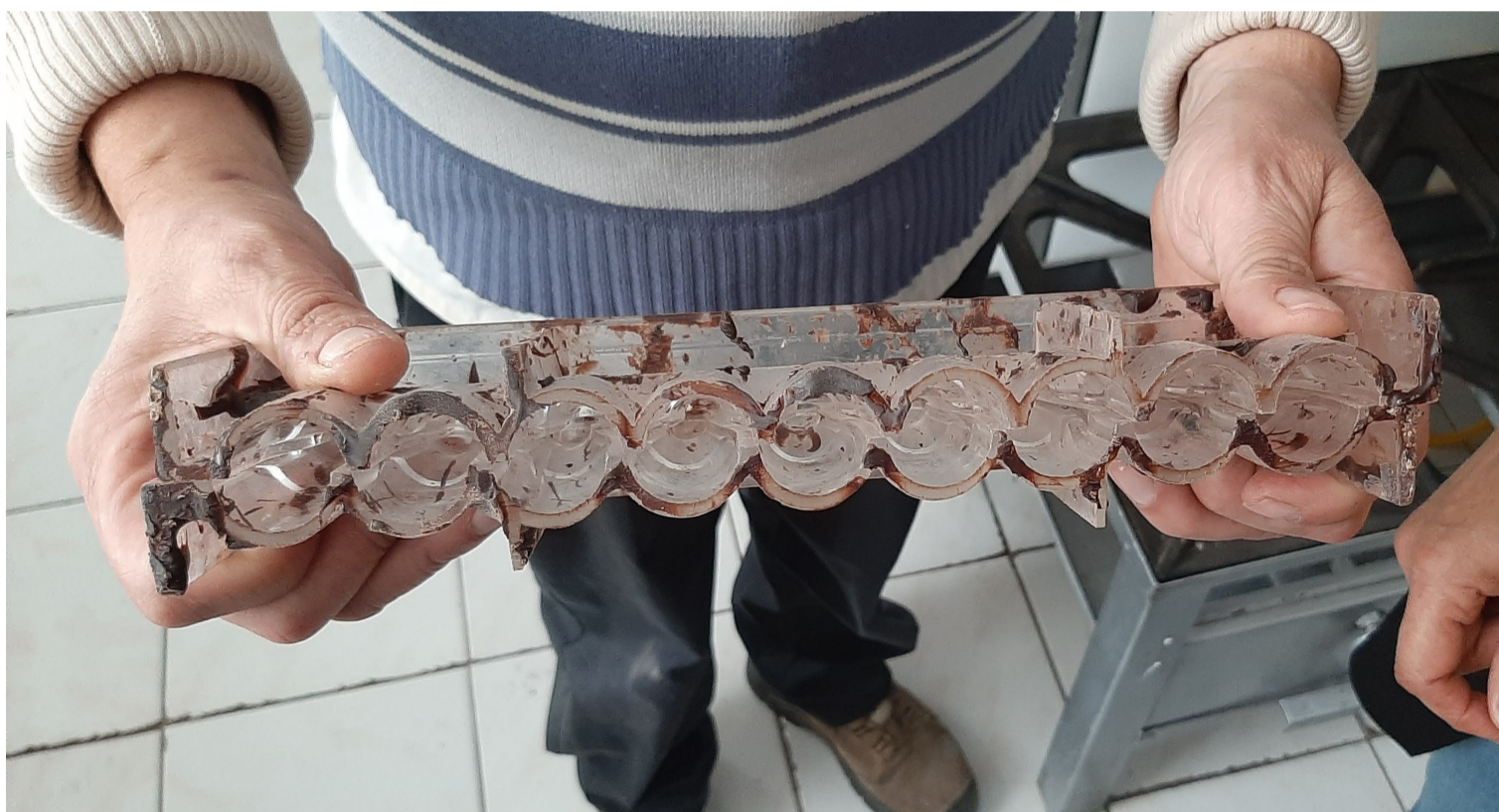
Molde doble de policarbonato para crear botellas de chocolate.
