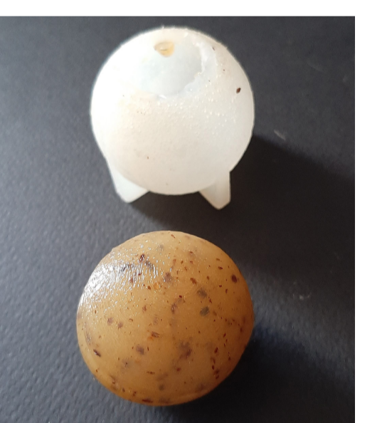
Quedando así un molde con mayor elasticidad y con mayor flexibilidad para desmoldar la preparación en su interior. El espesor óptimo para tener estructura firme y flexible varía entre 3 a 5mm.
