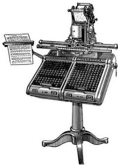
La monotonía constaba de una máquina con un teclado, como si fuera una máquina de escribir, con el que se compone el texto con una serie de matrices individuales de cada carácter en la que se funde en metal esa misma composición. Una vez impreso, el plomo se volvía a fundir y ya estaba listo para la nueva composición. Esta máquina es una variedad de impresión única; sólo salía una buena reproducción de cada lámina.
