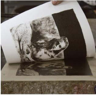
La litografía fue uno de los primeros sistemas de copiado y reproducción en serie de imágenes. La técnica está basada en el sencillo y fundamental principio de que “el agua y la grasa se repelen”. Para este tipo de impresión, se utiliza una matriz de piedra caliza pulida sobre la que se dibuja con pincel o lápiz graso. Durante el siglo XIX la litografía estuvo estrechamente vinculada al desarrollo de la prensa y fue uno de los sistemas más utilizados para la ilustración de libros.
