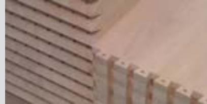
Se unen las partes con un mazo de goma y se presan con una máquina a presión la uniones de cola de milano y las uniones en ángulo agudo junto con los listones en ángulo agudo con la ayuda de una prensa.
