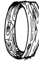
Ahora el segundo paso es posicionar verticalmente el aro de madera. Si bien resistió la primera carga (con un poco de asistencia ya que no podía quedarse de pie), en la segunda carga colapsó quedando aplastado.
