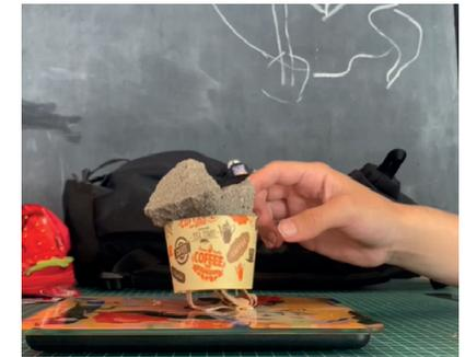
Se ha notado que la forma de una figura afecta tanto su resistencia como su rigidez. La primera figura mostró una mayor resistencia al soportar la carga de manera más efectiva, mientras la otra se partió en dos en sus puntos débiles.
