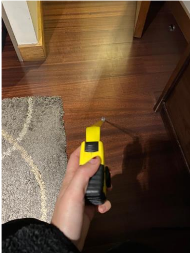
LADO 1. Huincha de medir por el lado convexo. Se observa que a los 50 cm ocurre el quiebre
