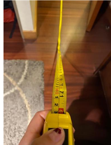
LADO 2. Huincha de medir por el lado cóncavo. A los 180 se produce el quiebre.
