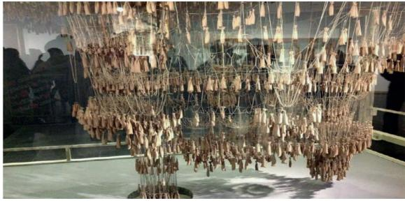
Se define **catenaria** como una curva que forma una cadena, cuya masa se distribuye uniformemente sujeta por sus dos extremos, mientras se somete únicamente a la fuerza de gravedad.
