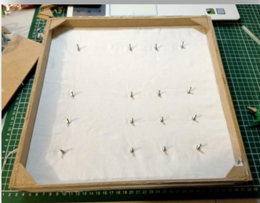
Molde final y pegado con apretadores para asegurar la base mientras se seca el pegamento.
