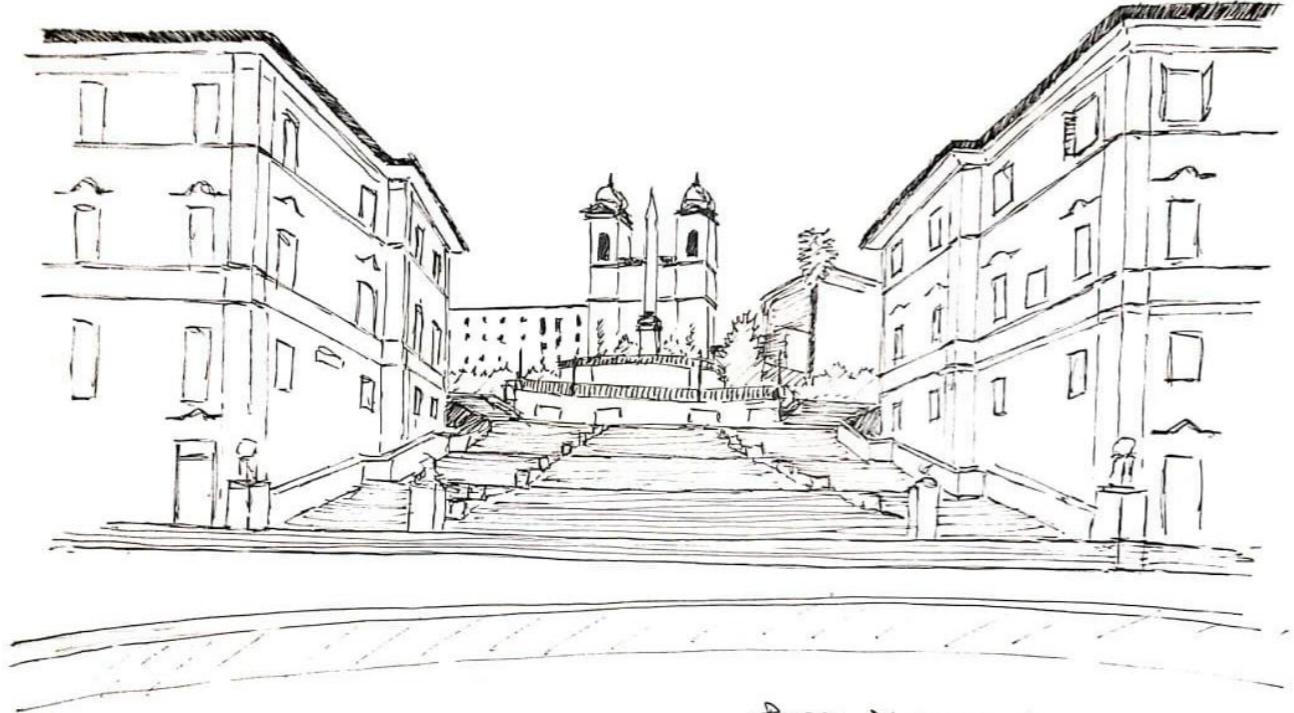
-Piazza di SPAGNA - Roma - SE OBSERVA UNA GRAN ESCALINATA SUBDIVIDIDA EN PRIMERA INSTANCIA SUBDIVIDIDA EN 3 PARTES CUYO CENTRO ES MAYOR EN ANCHO, SEGUIDO (HACIA ARRIBA) DE 2 DESCANSOS AMBOS COMO SEUDO-SEMI-CIRCUNFERENCIAS OPUESTAS CUYA UNA MAYOR PROFUNDIDAD COINCIDENTE CON LA ABERTURA DE LA PLAZA QUE VUELVE A ABRIRSE, COMO SI SU PRIMERA PARTE (LA DE LA ESCALINATA) FUERA UN EMBUDO, UNA ESTRECHURZA EFÍMERA. LUEGO LA PERSPECTIVA SE ENGRANDECE A SÍ MISMA MEDIANTE LAS VERTICALES DEJANDO A UN LADO LAS HORIZONTALES, ESTO PRIMERO GRACIAS AL OBELISCO Y SEGUIDO DE LAS 2 CÚPULAS. UNA EXTENSIÓN HORIZONTAL ASCENDENTE ESTRECHAMENTE EFÍMERA.
