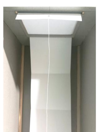
En esta vista se puede ver la zona que genera presión en este mecanismo, la cual consta de un marco que se distancia por 3 mm a través de una varilla, esto para que la cinta pueda correr de forma tensa a la hora de articularse.
