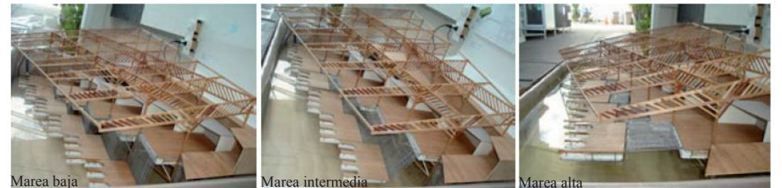
Modelo Hidráulico, verificación de flotación y transformación de la espacialidad del recinto ferial
