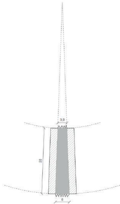
Para lograrlo se dibujó una extensión hacia arriba del lado izquierdo y del lado derecho, dibujados anteriormente, para que en algún punto se encuentren así formando un triángulo isósceles. La arista de la parte superior del triángulo servirá como punto para ubicar el compás que formará las bases curvas.
