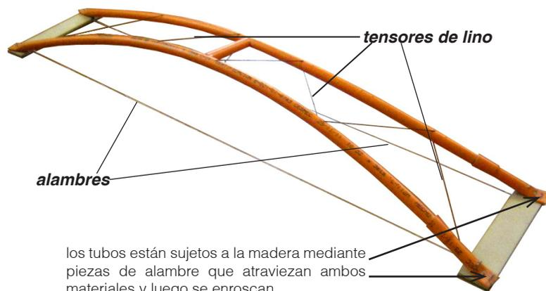
los tubos están sujetos a la madera mediante piezas de alambre que atraviezan ambos materiales y luego se enroscan.
