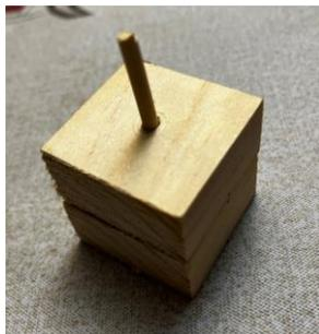
Las piezas quedan fijas sin rotación utilizando solo elementos de madera (sin ningún tipo de pegamento). El tarugo al ser introducido a presión (la madera lo permite) se deforma lo suficiente para entrar en el agujero uniéndose de esta forma las 2 piezas.
