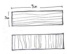
En este ejercicio se evaluará la resistencia de la madera entre dos trozos de la misma dimensión, pero con la diferencia en que un trozo tendrá sus betas verticales, y el otro, horizontales. Cortamos dos trozos de madera de 3x9cm.
