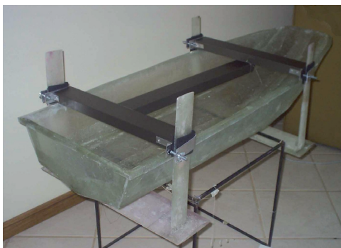
Modelo y perfiles alares para someterlo a prueba de arrastre
