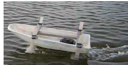
Pruebas de arrastre modelo, verificación sustentación y estabilidad, Estero Mantagua
