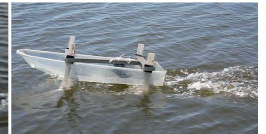
Pruebas de arrastre modelo, verificación sustentación y estabilidad, Estero Mantagua
