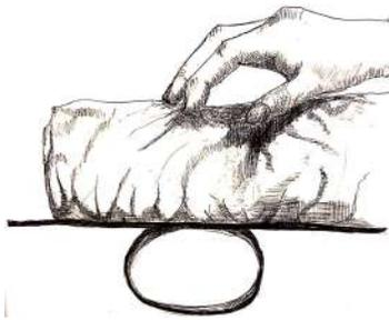
Al apoyarle una bolsa de lentejas de 1 kg a la viruta esta logra resistir un par de segundos antes de colapsar, no logra estar estática sosteniendo el total.
