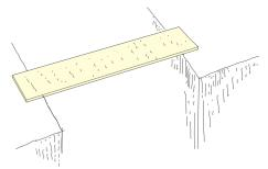
En un primer momento se procede a ubicar el trozo de madera (con fibras transversales) entre 2 cajones con cierta separación entre ellos y del suelo, para poder ver la resistencia de esta ante los pesos puntales a aplicar.
