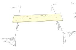
En conclusión, podemos decir que aquel trozo de madera con fibras longitudinales, en la cual sus fibras iban respondiendo aplicada (Fuerza A) , lograron consiguieron una mayor resistencia , hasta casi duplicando en comparación a las fibras transversales. Puesto que su dirección y forma que convergen con la forma alargada del trozo de madera permite tener una mayor resistencia al corte , mediante la deformación y flexibilidad que tienen las fibras contrarrestando el punto de corte.
