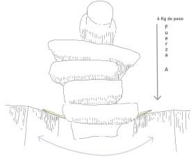
Madera sostiene el peso aplicado , pero sufriendo cambios notorios en su forma (Deformación)
