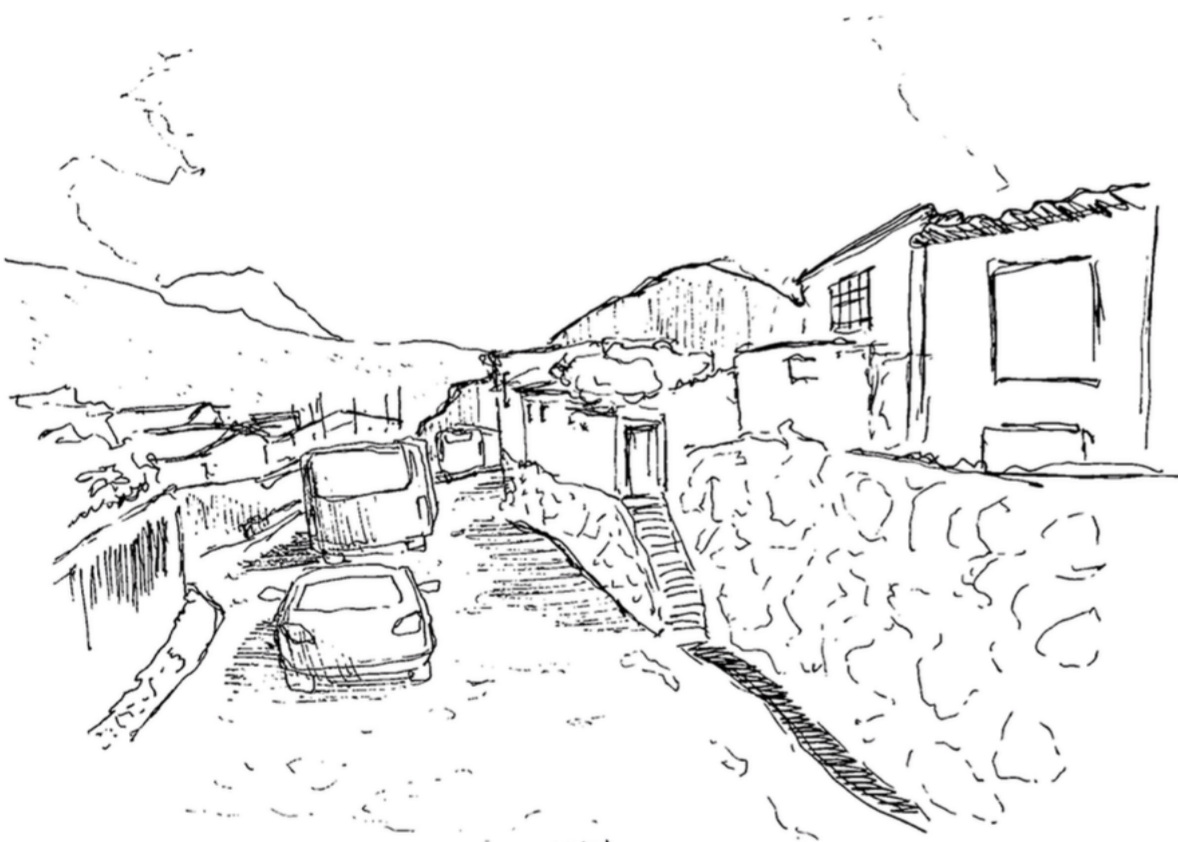
El zocalo como elemento nivelador de la horizontalidad en la parte baja, se ve una base, que a la altura nivela el terreno dejando el acceso a unos 1.20 mts de altura, estableciendo una nueva horizontalidad en lo alto creando una base en estilo de pedestal que eleva la casa hasta una llanura habitable en su extensión.
