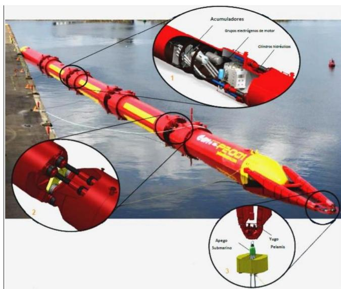
Imagen 4. Sistema pelamis, detalle de articulación.
