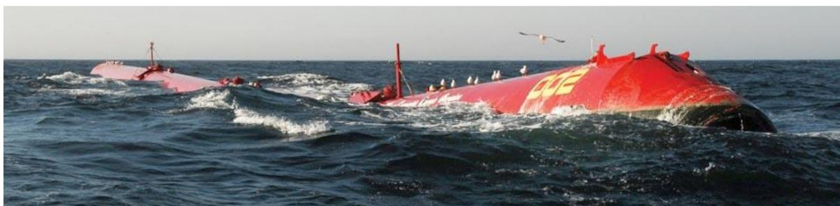
Imagen 5. Sistema pelamis accionado por el oleaje.
