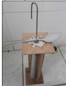
Vaciar la mezcla en el moldaje. Mantener el alambre centrado arriba con la misma cuchara.
