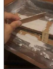
Al bajar el volumen, la superficie queda curva, por esto se llenó hasta rebalsarlo un poco, quitando el exeso y perfilando con un pedazo de madera. Cuando frague dejar secar dos días en un lugar seco.
