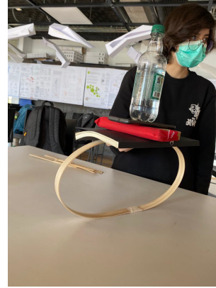
Se le aplica mas fuerza La deformación se hace presente, la fuerza se localiza en los laterales
