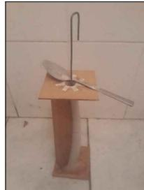
Vaciar la mezcla en el moldaje. Mantener el alambre a 0.5 cm del borde del círculo con la misma cuchara.
