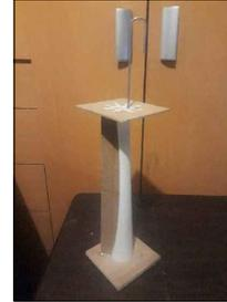
**Moldaje terminado.** Colocar el alambre en la guía. Arriba queda a 0.5 cm del borde del círculo.
