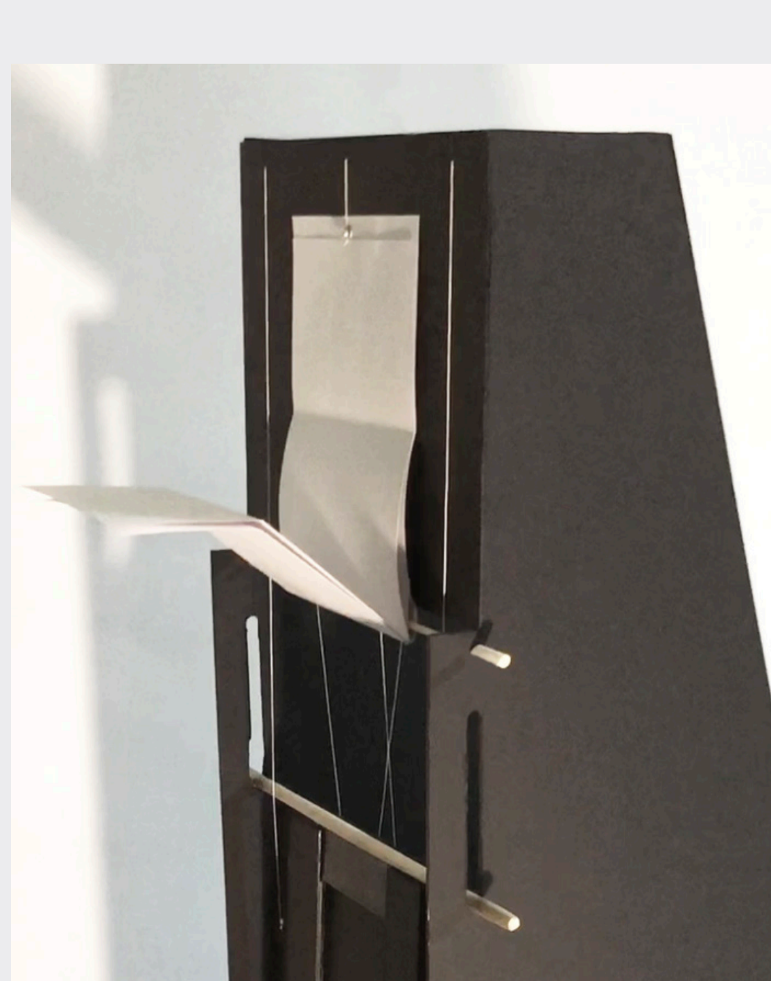
En esta vista en ángulo se muestra el despliegue y como caen las páginas una vez que se sueltan por el imán y se observan ambos rieles por los cuales sube el plano inferior para lograr cerrar el cuadernillo.
