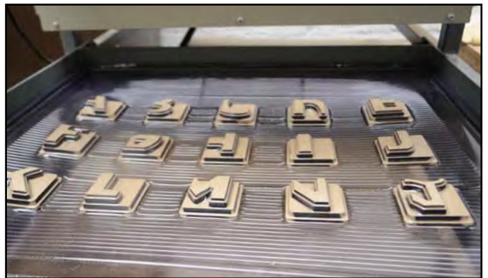
Al momento de bajar la palanca, las matrices quedaron enganchadas al la mica.
