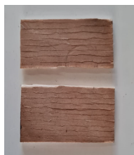
El trozo 1 se rompe de acuerdo a la dirección de las fibras de la madera.
