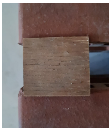
Trozo 1 - fibras en posición horizontal, en dirección al apoyo.
