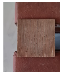
Trozo 2 - fibras en posición vertical, perpendicular al apoyo.
