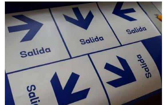
Figura 353-356. Producción en plotter de corte para Señalización de Salida, Vinilo Adhesivo Metamark 659. Elaboración Glenda Monforte.
