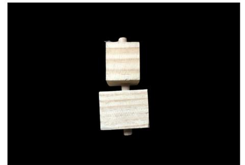
3. Se introduce el tarugo, a presión, en los dos trozos de madera. (el tarugo es levemente mas ancho que el orificio)
