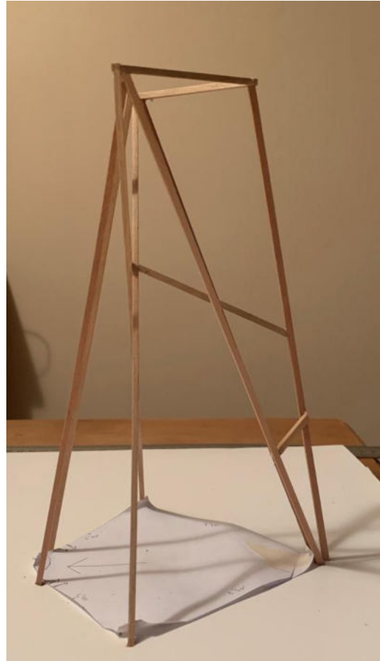
Imagen 72. Diagonales principales de la estructura ya posicionadas con ayuda del molde.
