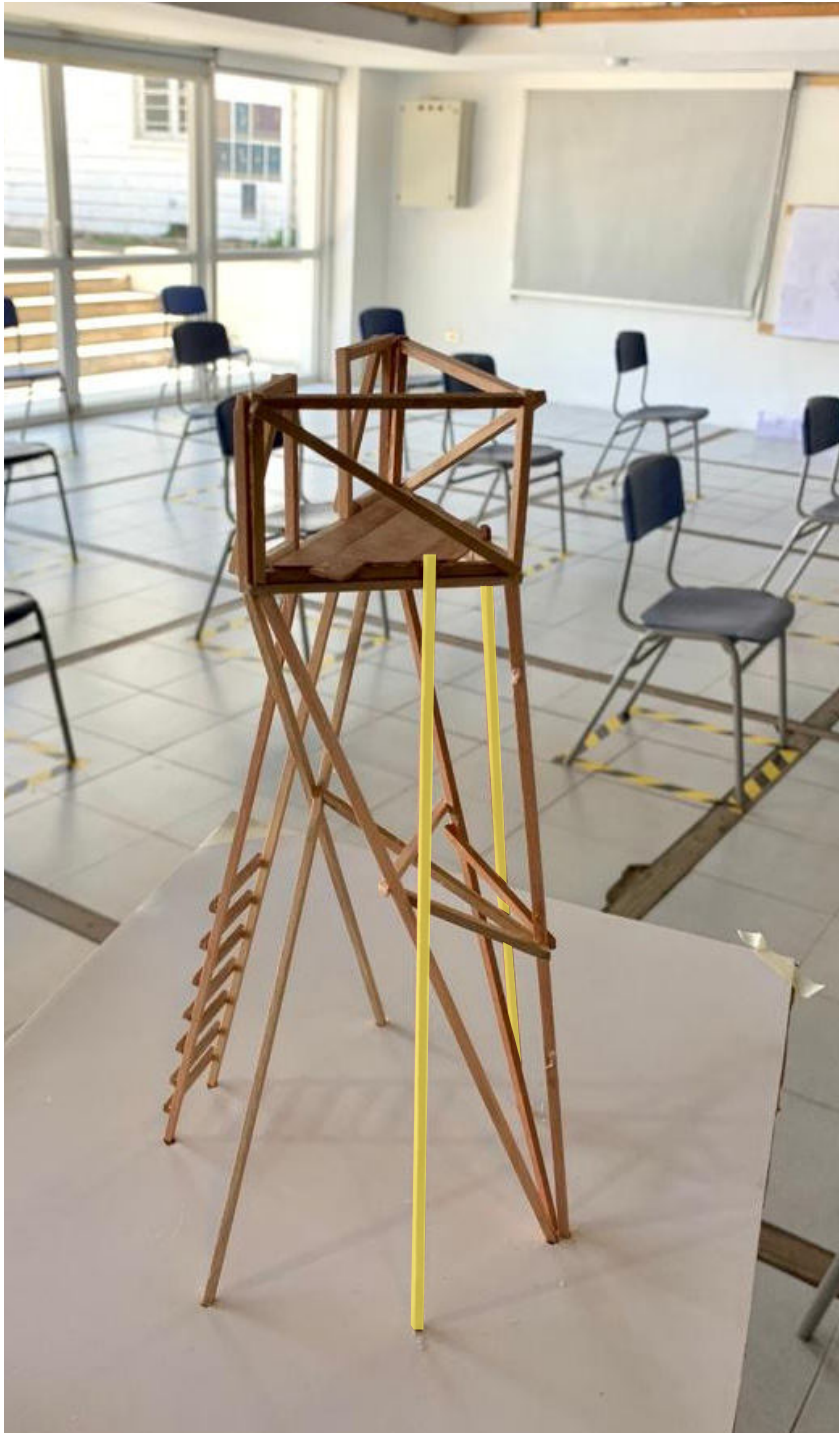
Imagen 75. Se le quitan soportes que sobre estructuraban la maqueta y se le agregan dos apoyos (color amarillo), uno a cada lado de la caseta para que ayuden a resistir los esfuerzos de tracción.
