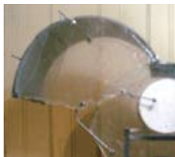
Posición que proporciona estabilidad a la tapa (casi horizontal)
