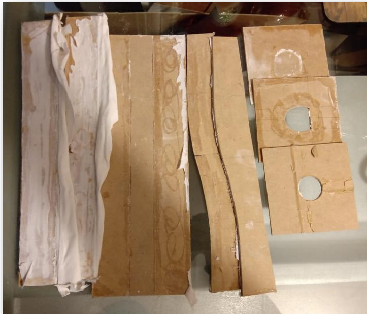
Matrices sobrantes una vez desmoldada la columna
