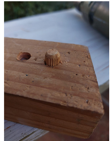
fig 4: las ranuras, pensadas para mayor sujeción de la cola, otorgan una mayor deformación ante la compresión
