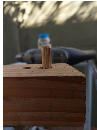
fig 3: vista lateral del tarugo dentro del tablón.
