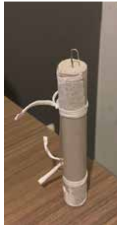
En la parte superior se ve el alambre que recorre la totalidad del pilar por el centro del cilindro.
