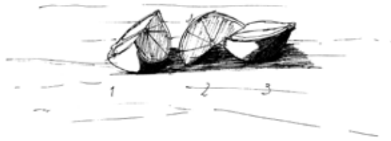
Croquis 36. Geometría interior conforma volumen exterior a geométrico. 1) Sentido y organización. 2) Corte muestra el perfil de la geometría. 3) Longitudinal que sostiene la membrana, cascara.
