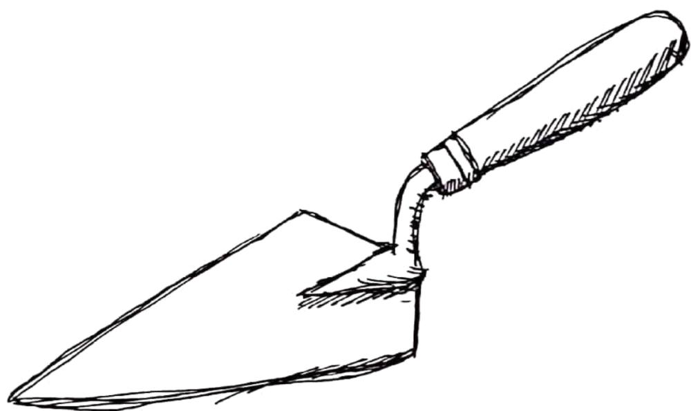
La Paleta de Albañil , es el instrumento que se usa para depositar la mezcla que tenemos preparada, por ejemplo si estas levantando un muro de ladrillos, con la paleta colocas el materia que une los ladrillos, también se usa para dar el revoque en muros y paredes, en este caso el albañil carga la paleta con la mezcla que tiene en un balde o cubo y lo lanza a la superficie que quiere revocar.
