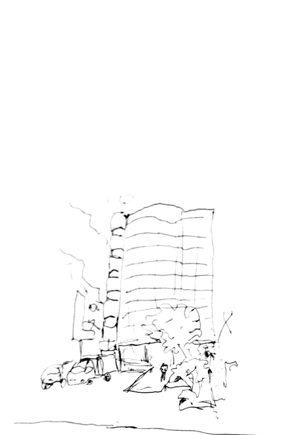
La entrada al edificio posee un desnivel y una rampa. De esta forma, hay una pequeña detención al momento de entrar y salir, lo que sitúa al edificio levemente sobre el ras de la vereda, aumentando su presencia en fachada. Elevación de ras por zócalo aumentador de presencia.
