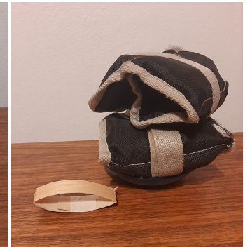
El cilindro colapsa abruptamente con el peso y se rompe en sus extremos laterales.
