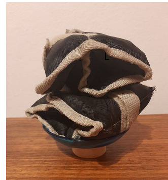
El cilindro se somete a un peso de 4 kg.
