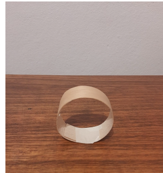
El cilindro se somete al peso de 4 kg en posición vertical.
