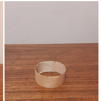
El cilindro presenta roturas en el sentido de las fibras.
