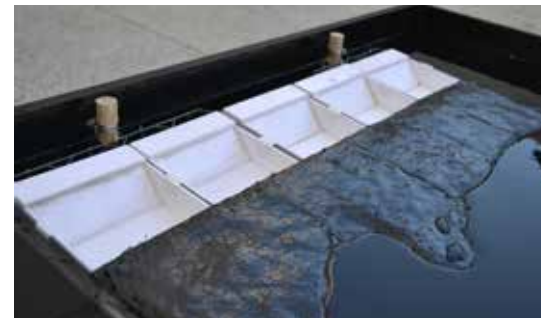
Detalle de los flotadores que aportan la boyantez para modelar el borde costero.
