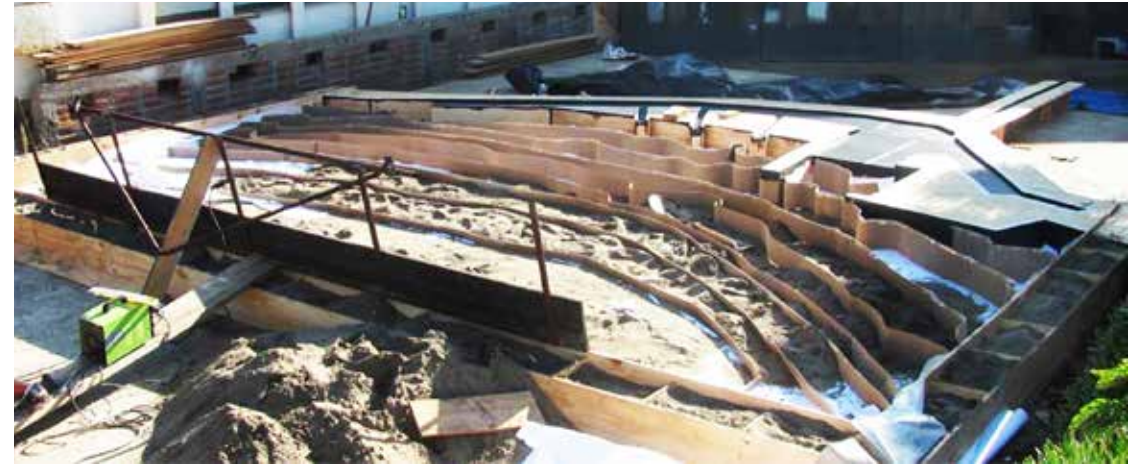
Forma tradicional de crear un modelo en plataforma marítima con franjas de cartón corrugado y arena. Fuente: Tesis Pablo Vásquez
