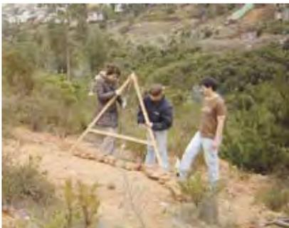
FIGURA III.9 Trazado de curvas de nivel utilizando el nivel tipo "A"
