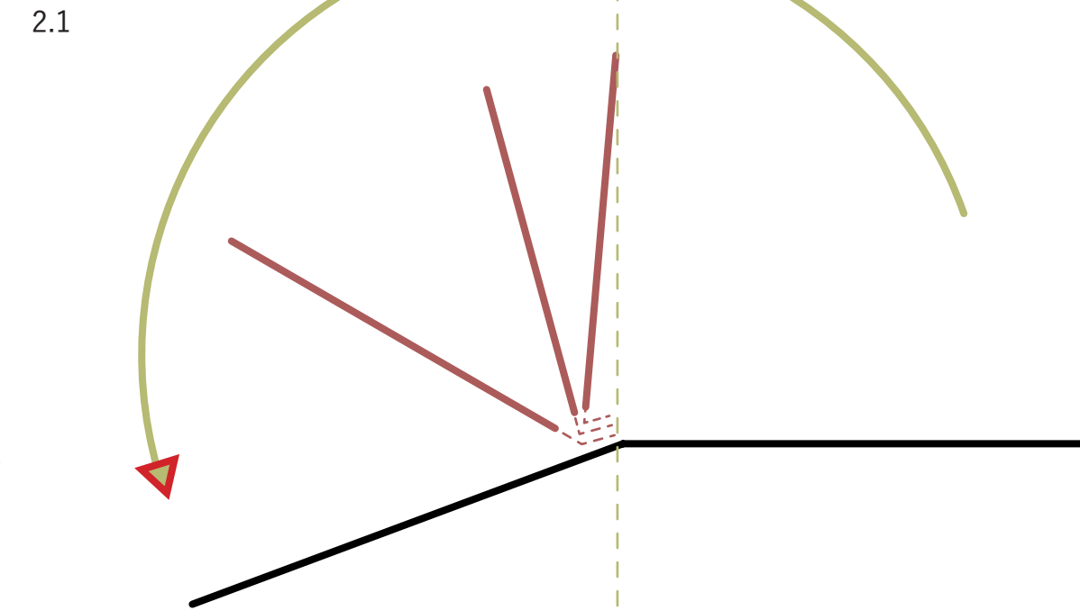
2.1- Las hojas comienzan a caer por su propio peso, debido a la fuerza que se le ejerce al retraer una de las "tapas".
