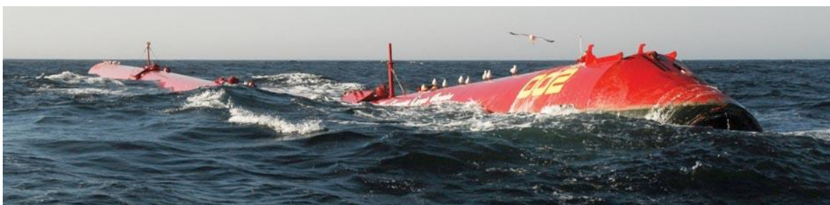
Imagen 5. Sistema pelamis accionado por el oleaje.
