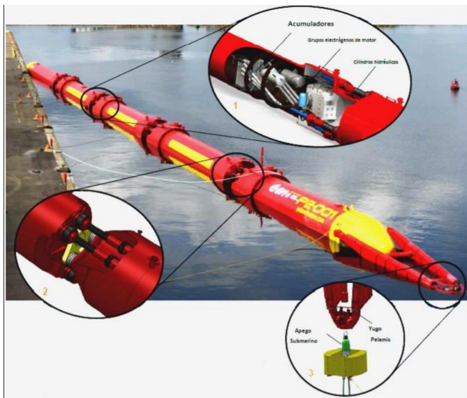
Imagen 4. Sistema pelamis, detalle de articulación.
